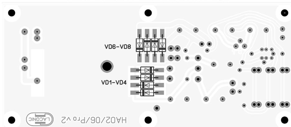
Расположение элементов на плате БП со стороны печатных проводников
