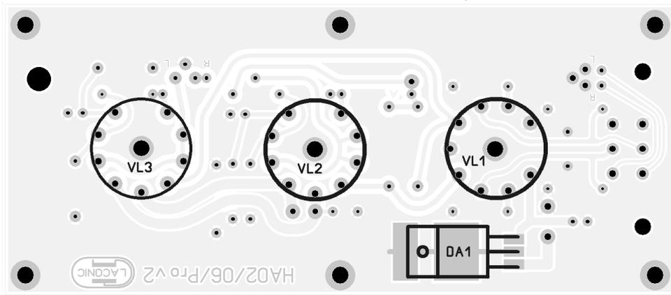
Расположение элементов на плате усилителя со стороны печатных проводников
